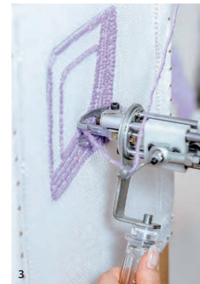
1 마이페이보릿팅스에서 제공하는 실. 2 뒷면에 라텍스로 풀질하는 모습. 3 터프팅 건을 이용해 천에 실을 심는 중이다. 4 완성한 트레이와 실.
